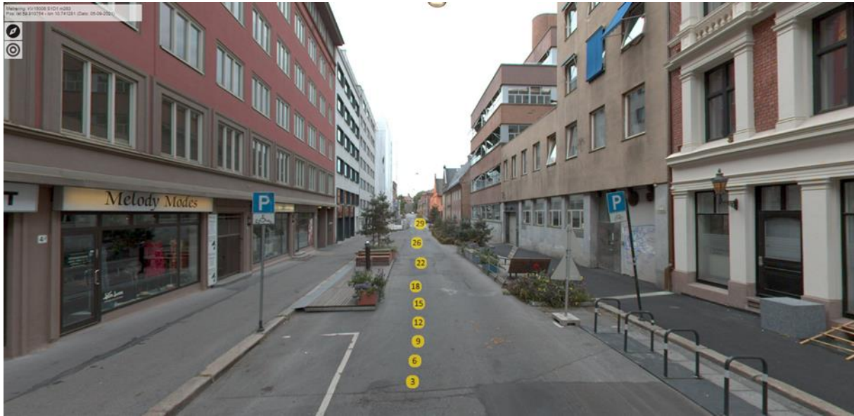
Figur 8. Etterslep skiltpunkt – registrert skjev stolpe (se skilt til høyre i bildet). Skiltet er samtidig posisjonsfestet og identifisert med riktig skiltplate og underskilt
