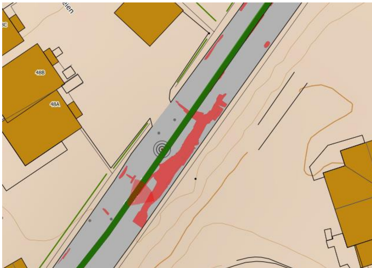
Figur 10b. Skannet dekkeskader i Frysjeveien (Kv 12069), samme veisegment som vist i figur 10a
