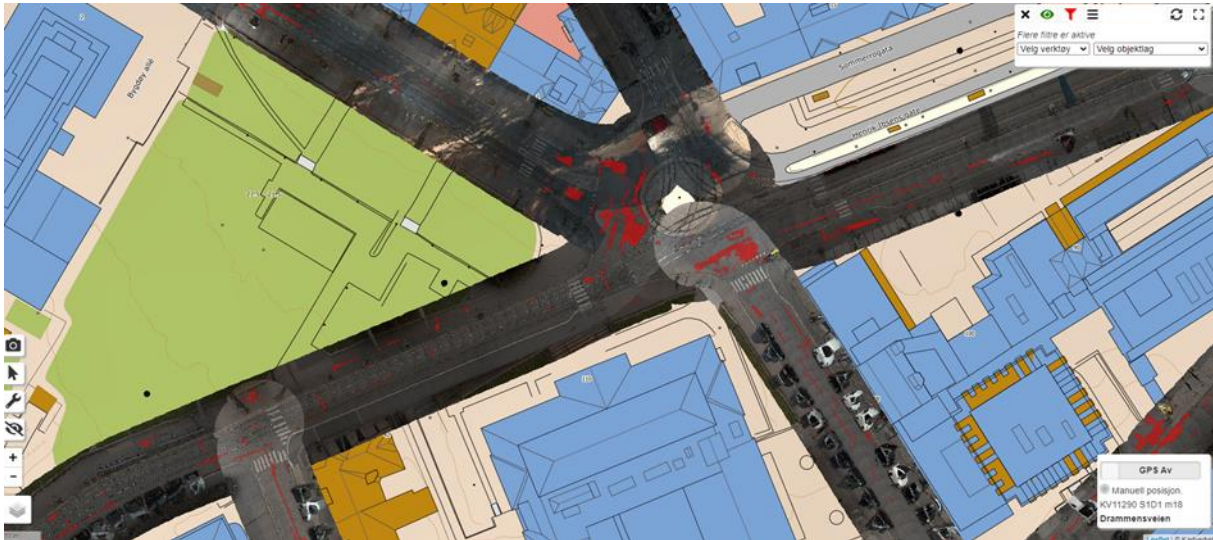
Figur 10d. Skannet veinett med dekkeskader
