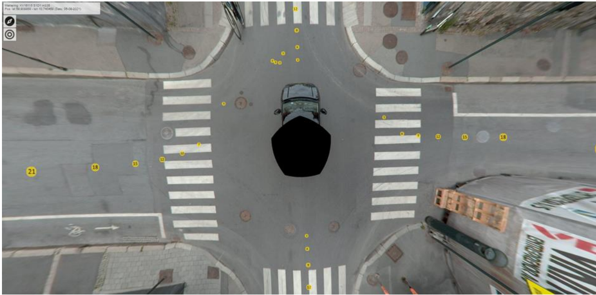
Figur 5b. Sammensatt veibilde fra ett veipunkt utfra 360-bilder og 6-linset kamera
