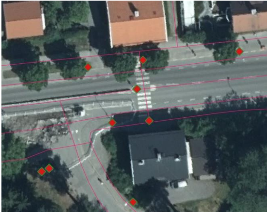
Figur 7a. Automatisk gjenkjenning av skilt. Her er posisjonen på skilt automatisk fastsatt og innmålt ved hjelp av skanning og bruk av GPS montert i registreringsbilen.
