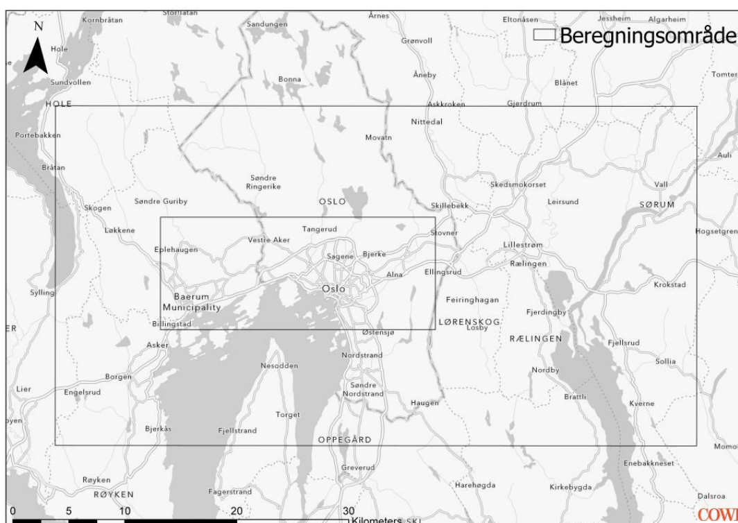
Figur 1 Kart 1 De to områdene som er anvendt i beregningene. Det største området har en oppløsning på 300 x 300 meter, området innenfor den mindre rammen har en oppløsning på 50 x 50 meter. Kilde: COWI
